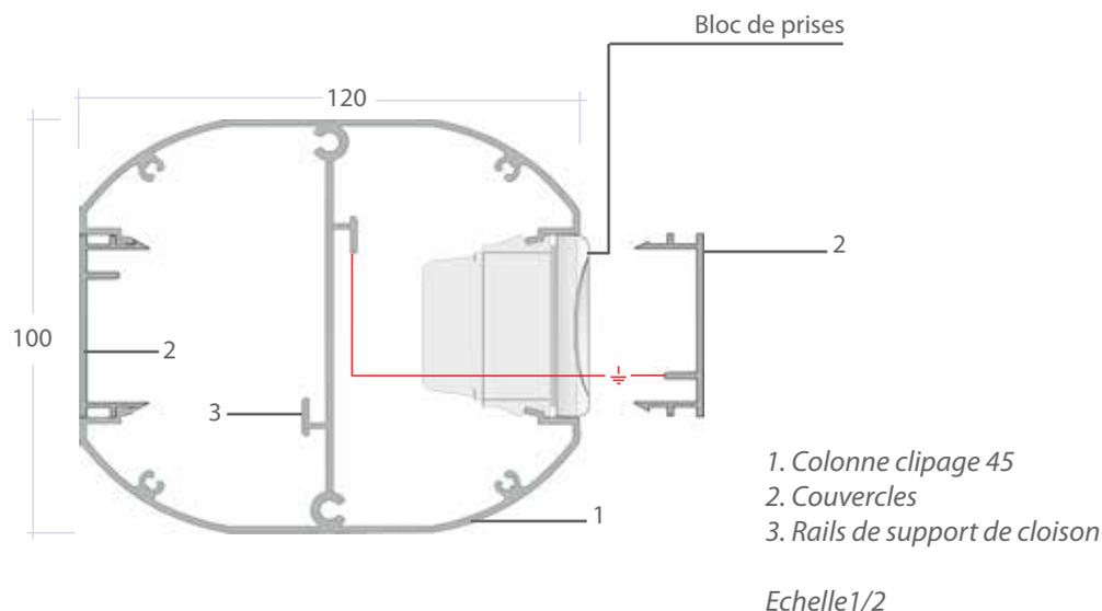
Tous nos profils de colonne autoportée ont une hauteur de 2,20 m et un tube de raccordement de 1,50 m. Une embase de 15Kg avec un encombrement de 320 x 320 mm. La colonne est alimentée via une gaine souple par le plafond, avec une mobilité de rayon 1.25m pour un plafond n'excédant pas une hauteur de 2.5m. Longueur de la gaine souple sur mesure à la demande.
