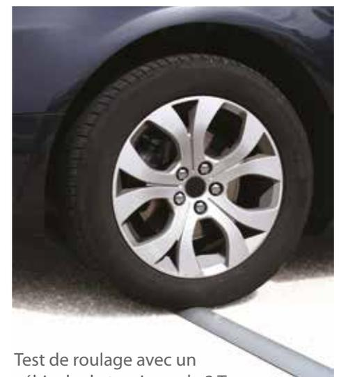
Test de roulage avec un véhicule de tourisme de 2 Tonnes. Indice de protection IP4X et IK08.
