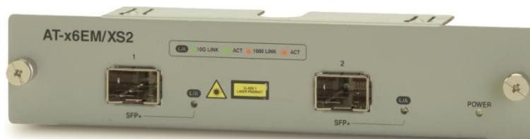
Ce module est équipé de deux emplacements SFP+. Il peut être utilisé pour ajouter 2 interfaces 10 Gbs à une unité ou comme module d'empilage. Le module x6EM/XS2 doit être retenu lorsque l'une au moins des unités de la pile est distante des autres unités.
